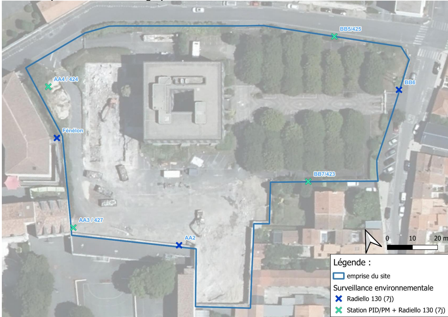
Points de mesure sur radiello 130 et stations de mesure COV par PID et de particules fines PM2.5 et PM10
